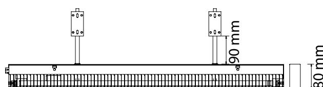
För två konsoler inkl. lysrör och tvär-lamellraster. Armaturhus i aluminium.
